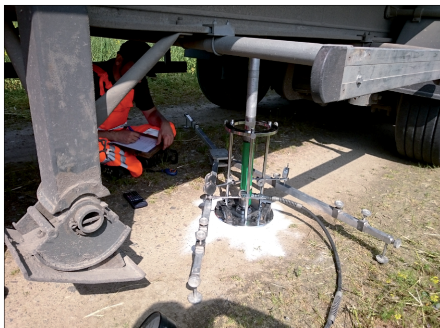
Fot. Przykład badania płytą VSS (Zachodniopomorskie Laboratorium Drogowe w Koszalinie)
