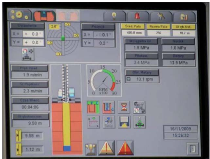
Fot. 2 | Wyświetlacz urządzenia rejestrującego w czasie betonowania pala
