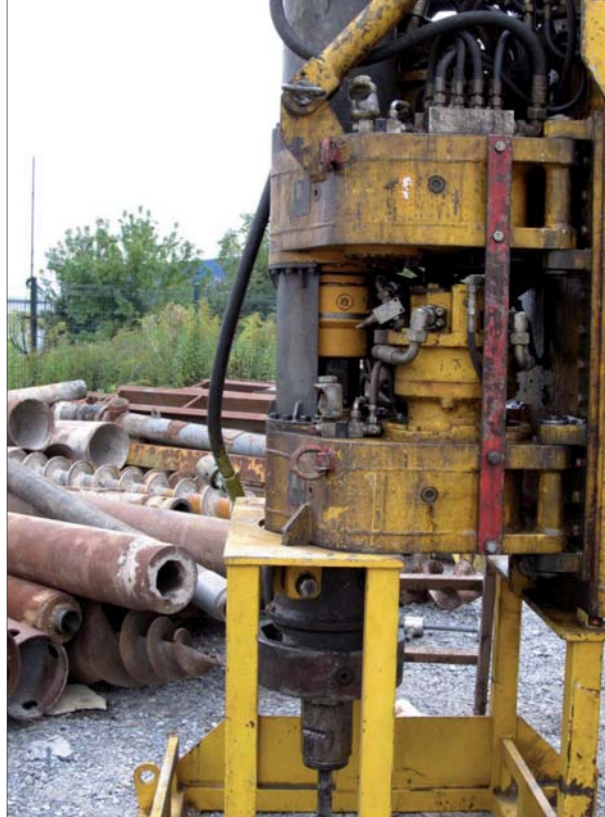
Fot. 5 | Głowica obrotowa do wykonywania palisad (VDW). Widać, że część do zamontowania rury jest najbardziej wystającym elementem głowicy
