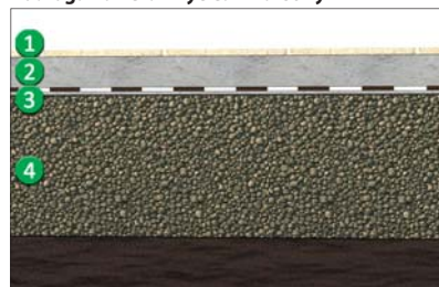
Podłoga na keramzycie: 4 warstwy
