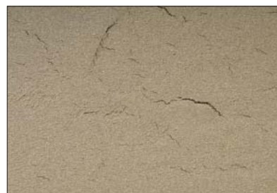
Fot. 5 Obraz spękań na powierzchni szlamu, który może mieć dwie przyczyny (opis w tekście) (fot. Weber Deitermann)
