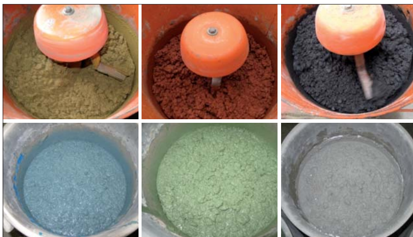
Fot. 2 | Kolorowy beton – świeża mieszanka betonowa
