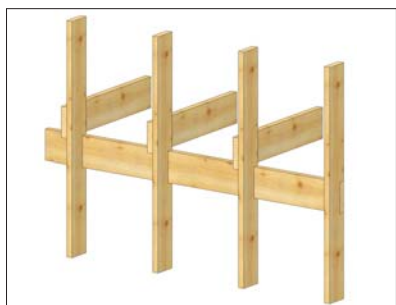
Rys. 7 | Oparcie belek stropowych w konstrukcji balonowej
