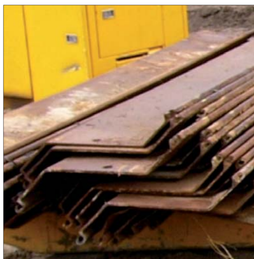
Fot. 1 | Grodzice typu Z i typu U (dwa połączone profile G62 po wbiciu w grunt)
