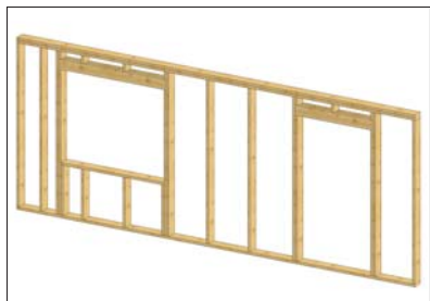
Rys. 8 | Typowa konstrukcja ściany zewnętrznej
