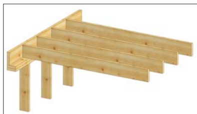
Rys. 10 | Konstrukcja stropu międzykondygnacyjnego
