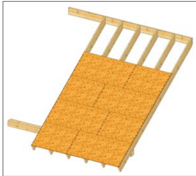
Rys. 13 | Zasady montażu płyt poszycia połączi dachu
