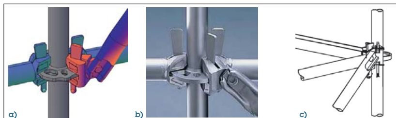
Rys. 4 | Węzły rusztowań modułowych: a) Altrad Mostostal Rotax, b) Layher Allround, c) Harsco Modex
