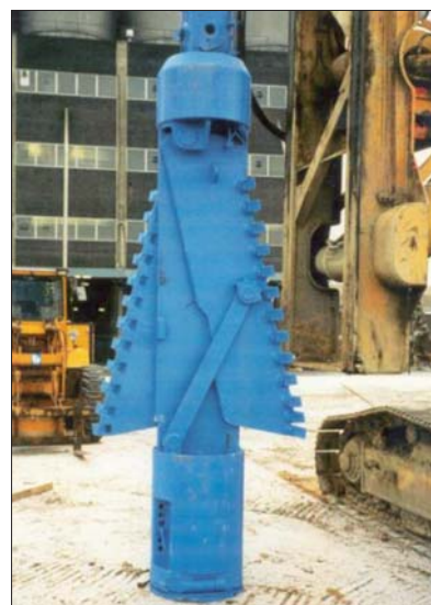
Fot. 5 | Rozwiertak do powiększania podstaw pali [2]
