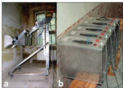
Fot. 3a, b | Generatory mikrofalowe stosowane do wstępnego osuszenia pasci iniekcji (fot. C. Magott)
