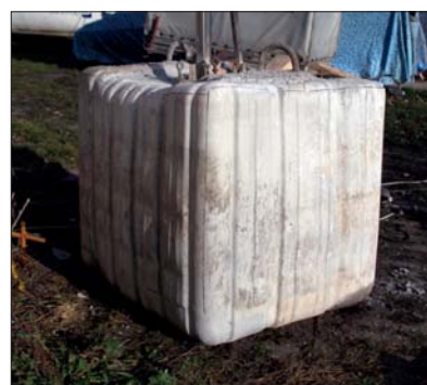
Fot. 3 | Zabetonowany element po wyjęciu z wody i rozformowaniu
