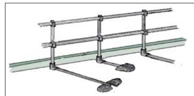
Rys. 2 | Wolno stojące (ruchome) balustrady do zabezpieczeń krawędzi dachów z przeciwwagami, nie naruszają poszycia dachu (rys. autorki)
