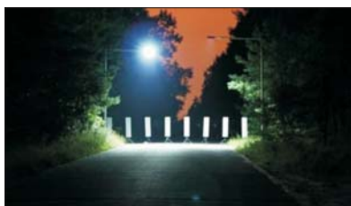
Przejście dla pieszych oświetlone systemem SSOD® (w tle widoczne makiety imitujące sylwetkę pieszego w różnych punktach przejścia) Dane udostępnione dzięki uprzejmości dr. Piotra Tomczuka – Wydział Transportu Politechniki Warszawskiej.
