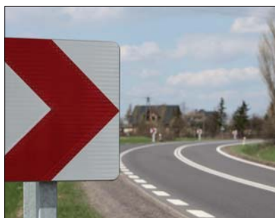
Zastosowanie znaków U-3a na łukach drogi (szczególnie gdy oznakowanie poziome jest mało czytelne lub go brak) w doskonały sposób prowadzi kierowcę po określonym torze jazdy
