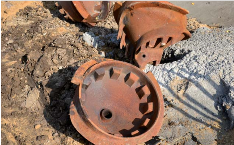
Fot. 2 | Stalowa podstawa pali
