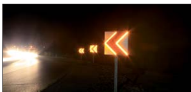
Zastosowanie znaków U-3a na łukach drogi (szczególnie gdy oznakowanie poziome jest mało czytelne lub go brak) w doskonały sposób prowadzi kierowcę po określonym torze jazdy
