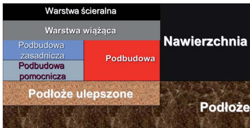
Rys. 2 | Konstrukcja nawierzchni asfaltowej
