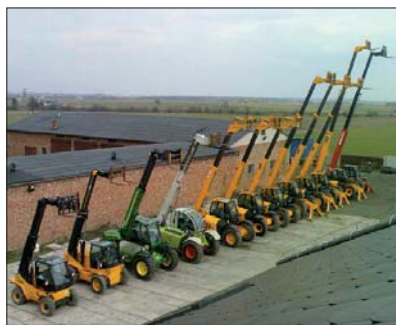
Fot. 3 | Ładowarki teleskopowe (Kalska Wola)
