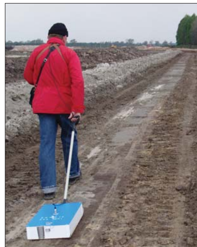
Bezinwazyjne badanie przesłony – metoda georadarowa
