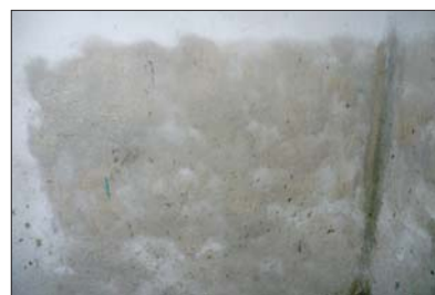
Fot. 2 | Faza rozrostu struktur krystalicznych i wypierania wody
