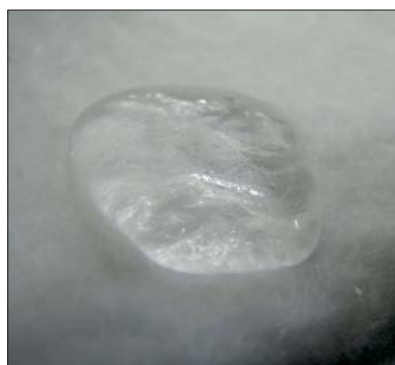
Fot. 1 | Hydrofobowe właściwości maty aerożelowej – kropla wody na macie (fot. autor)
