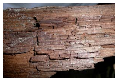
Fot. 3 | Przykład destrukcyjnego rozkładu drewna, tzw. rozkład brunatny, przyrzątkowy
