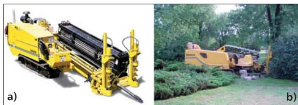
Fot. 2 | Wiertnice do przewiertów poziomych firmy Vermeer: a) ogólny widok wiertnicy, widoczny zintegrowany z nią magazyn żerdzi wiertniczych; b) wiertnica podczas wykonywania przewiertu pod Trasą Łazienkowską w Warszawie – prace są wykonywane bez szkody dla otaczającej zieleni
