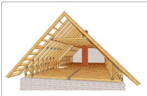
Rys. 3 | Prefabrykowane więzary na poddasza mieszkalne
