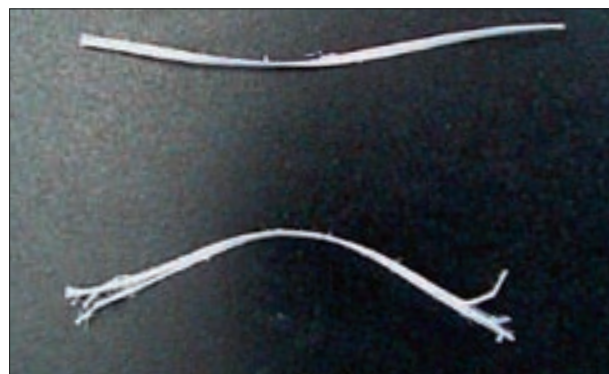
Rys. 1 | Widok makrowłókien CHRYSO®Fibre S przed i po wymieszaniu ze składnikami mieszanki betonowej
