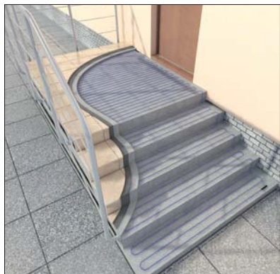
Fot. 1 | Ułożenie przewodów grzejnych jednostronnie zasilanych ELEKTRA VCD25
