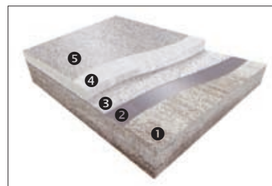
Rys. 3 | Gładka posadzka cienko- lub grubowarstwowa: 1 podłoże, 2 gruntownik, 3 posypka z piasku kwarcowego, 4 kompozycja podstawowa, 5 lakierowanie zamykające (opcjonalnie)
