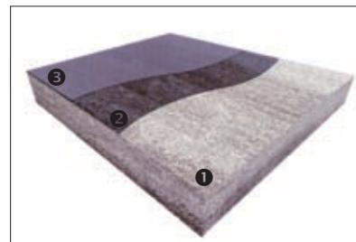
Rys. 2 | Gładka powłoka ochronna: 1 podłoże, 2 żywica ochronna (pierwsza warstwa), 3 żywica ochronna (druga warstwa)
