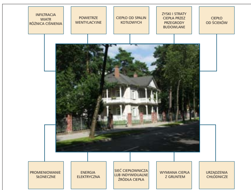
Rys. 1 | Wymiana ciepła budynku z otoczeniem
