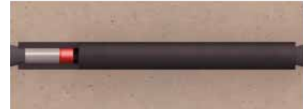
Rys. 6. Uszczelnienie przejścia ściągu przez ścianę zbiornika – rurka FB 22/40 zamknięta stożkami z betonu architektonicznego wraz z akcesoriami zamocowanymi na klej A+B
