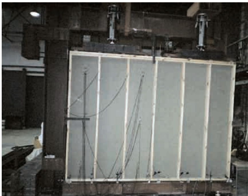
Element stropowy na stanowisku badawczym (badany w orientacji pionowej)
