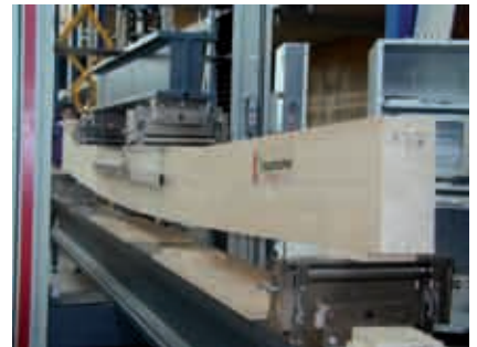
Fot. Badania belek wzmacnionych włóknami aramidowymi
