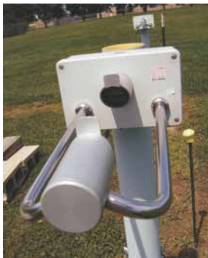
Rys. 1. Produkowane seryjnie disdrometry laserowe: po prawej disdrometr Parsivel firmy OTT Messtechnik GmbH & Co. KG, po lewej disdrometr firmy Thies Clima
