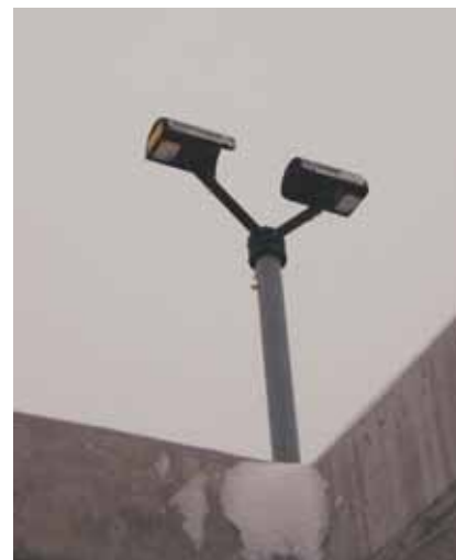
Rys. 1. Produkowane seryjnie disdrometry laserowe: po prawej disdrometr Parsivel firmy OTT Messtechnik GmbH & Co. KG, po lewej disdrometr firmy Thies Clima
