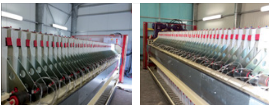
Fot. 5. Minimalizacja kubatury/masy odpadu za pomocą prasy filtracyjnej
