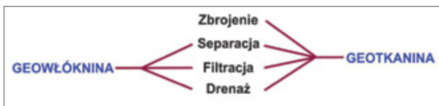
Rys. 1. Funkcjonalność geowłóknin i geotkanin
