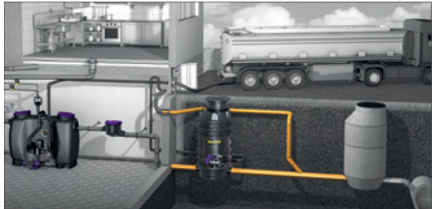
Przepompownia hybrydowa Ecolift XL podłączona za separatorem tłuszczu KESSEL Easy Clean
