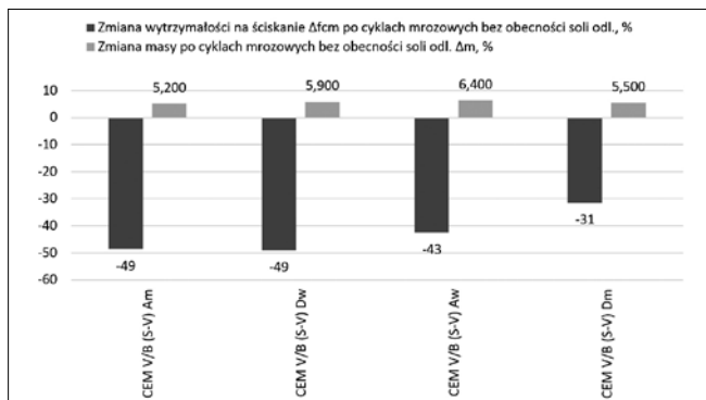
Rys. 6. Mrozoodporność wewnętrzna betonów z cementem napowietrzającym CEM V/B (S-V)
