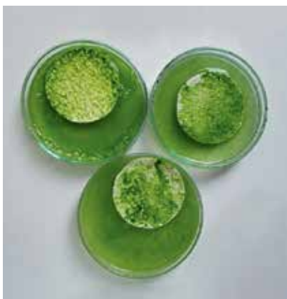
Próbki bez środków biocydowych po wymywaniu. Próbki porażone przez glony
