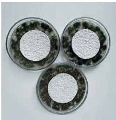
Powłoka z dodatkiem biocydów po wymywaniu. Skuteczność na porastanie grzybami pleśniowymi
