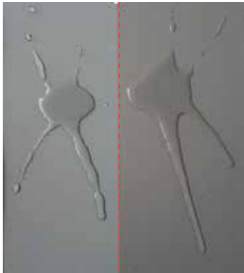
Tzw. efekt kropli wody. Próbki wykazują podobną hydrofobizację
