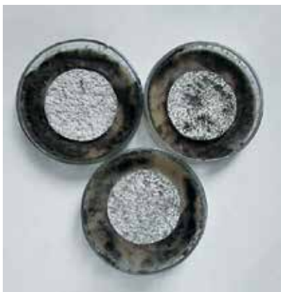
Próbki bez środków biocydowych po wymywaniu. Próbki porażone przez grzyby pleśniowe
