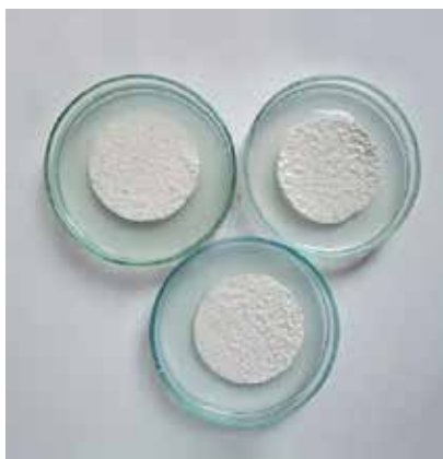
Powłoka z dodatkiem biocydów, po wymywaniu. Skuteczność na porastanie algami
