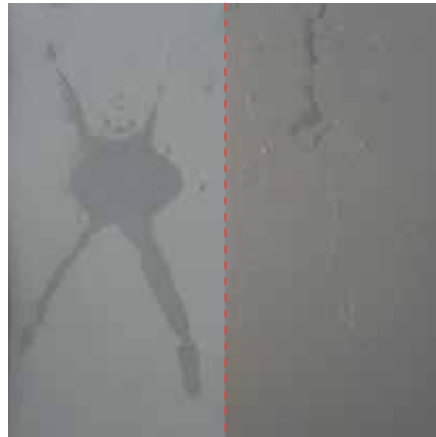
Wygląd po strząśnięciu. Po gwałtownym strząśnięciu wody z powierzchni obu powłok malarskich próbka po lewej stronie nasiąkła wodą na całej powierzchni, na której zalegała. SALTA N PLUS wykazuje prawie 100% brak nasiąkliwości i wynikający stąd brak przebarwienia powierzchni
