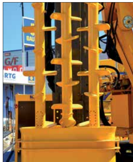
Fot. 5. Potrójne mieszadło DSM
