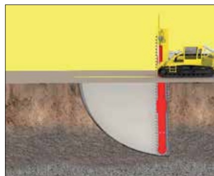
Fot. 9. Sposób zagłębienia się miecza trenczmiksера w grunt
