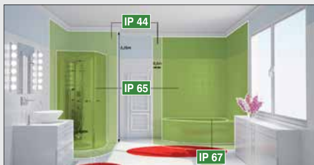
Rys. 1. Stopień ochrony obudowy sprzętu elektrycznego w strefach 0, 1 i 2 według zasad dobrej praktyki
