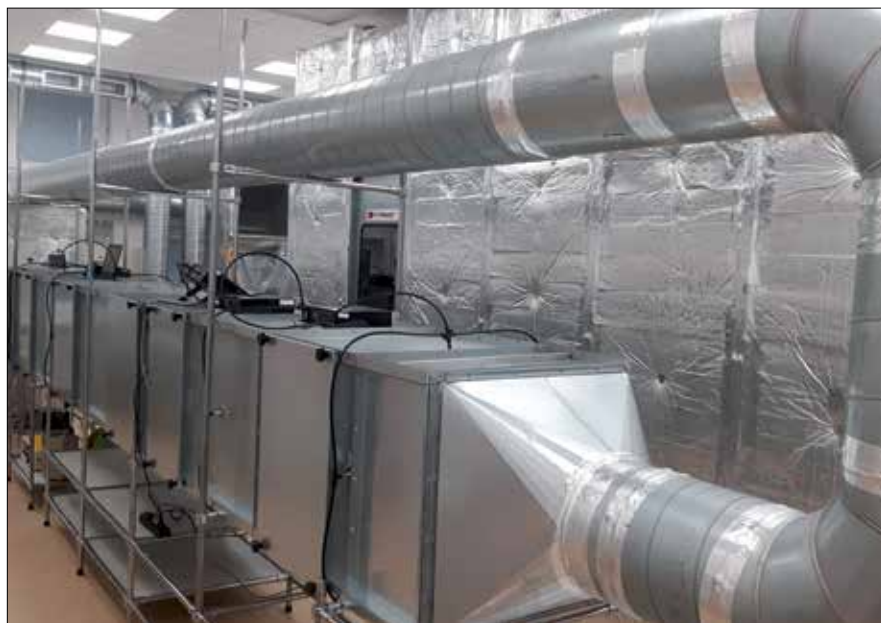
Fot. Stanowisko do badania parametrów użytkowych filtrów powietrza zgodnie z PN-EN ISO 16890
