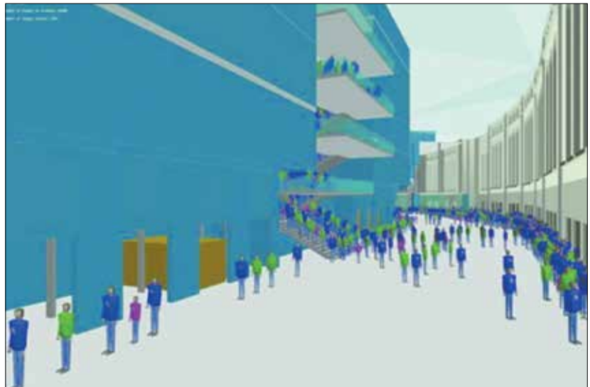
Rys. 5 | Zastosowanie BIM 8D do modelowania drogi ewakuacyjnej [11]
