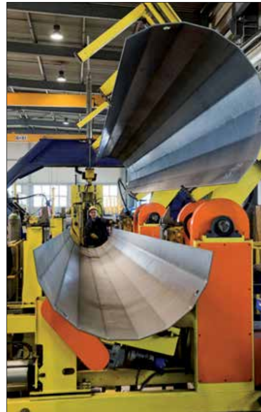
Fot. 2 | Przykład trzonu składanego z dwóch łupek [4]
