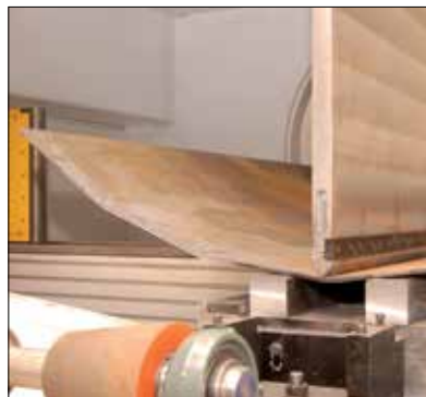
Fot. 1 | Przykład formowania łupki słupów wielokątnych [4]
