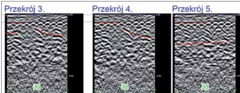
Rys. 2 | Widoczne raki i niejednorodności betonu na poboczniczy elementu prefabrykowanego
