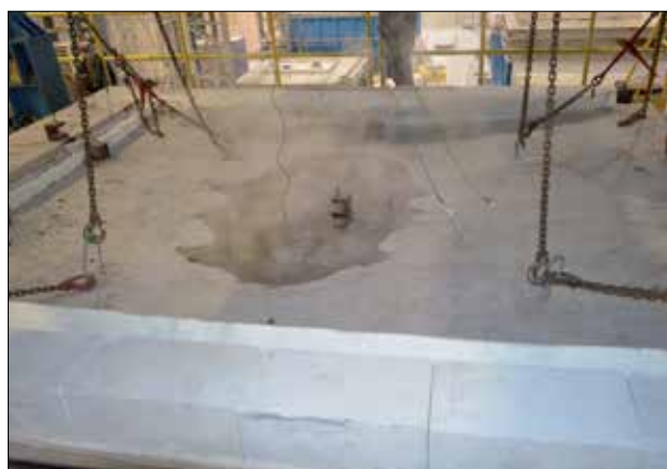
Fot. 2d | Strona nienagrzewana żelbetowej płyty o grubości 15 cm. Oddziaływanie standardowe od dołu. T = 120 min
