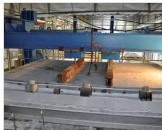
Fot. 1b | Strop jak na fot. 1a po 120 min oddziaływania standardowego
