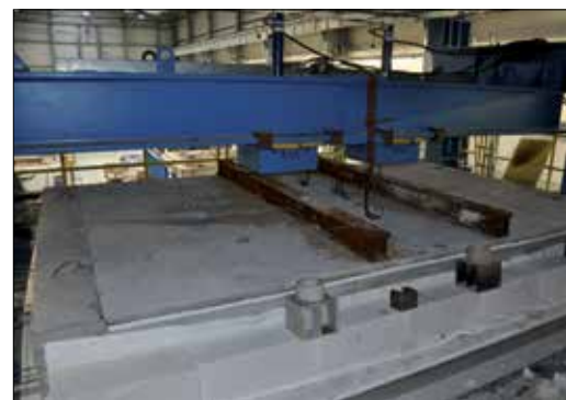
Fot. 1a | Strop gęstożebrowy na belkach sprężonych, rozpiętość w świetle podpór 424 cm, grubość 36,5 cm, pustaki betonowe o wysokości 20 cm i szerokości 53 cm. Strona nienagrzewana, widok przed badaniem
