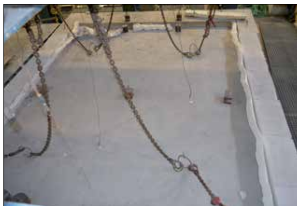
Fot. 2a | Strona nienagrzewana żelbetowej płyty o grubości 15 cm. Oddziaływanie standardowe od dołu. T = 0 min
