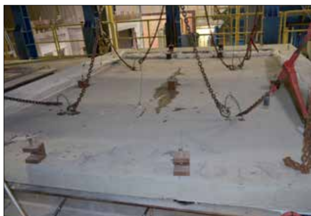
Fot. 2b | Strona nienagrzewana żelbetowej płyty o grubości 15 cm. Oddziaływanie standardowe od dołu. T = 30 min
