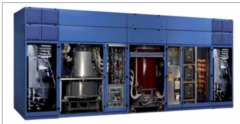
Fot. 3 | Dynamiczny zasilacz RUPS firmy Piller Power Systems. Po lewej stronie zasobnik energii kinetycznej z kołem zamachowym, w środku maszyna synchroniczna silnik-prądnica [12]
