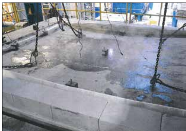
Fot. 2c | Strona nienagrzewana żelbetowej płyty o grubości 15 cm. Oddziaływanie standardowe od dołu. T = 60 min
