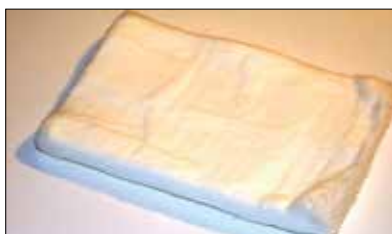
Rys. 4 | Fragment maty z granulatem aerożelowym
