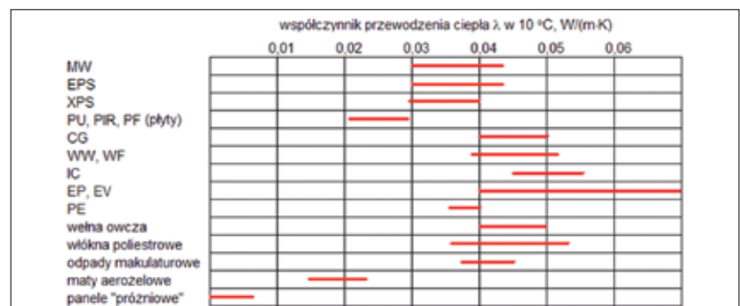
Rys. 1 | Orientacyjne wartości współczynnika przewodzenia ciepła różnych rodzajów izolacji cieplnych
