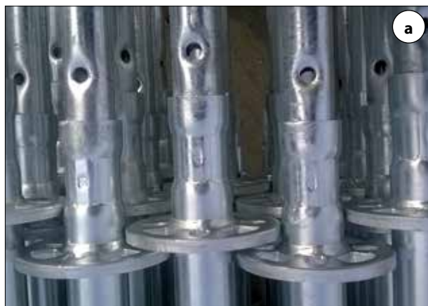
Fot. 2 | Informacja o posiadanym certyfikacie bezpieczeństwa „B” umieszczana na elementach rusztowań modułowych SKYER: a) oznakowanie stojaka – rok produkcji 05; b) oznakowanie podestu – rok i oznaczenie producenta
