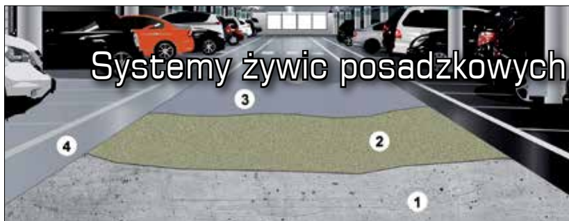
Fot. 1 Posadzka parkingu: 1) posadzka betonowa; 2) podkład gruntujący Almacoat Primer Concrete®/Primer Concrete Fast®; 0,3 mm; 3) warstwa polimocznikowa Almacoat Floor®; 2-4 mm; 4) farba Almapur Protect/Almapur VVHS®; 0,3 mm (opcjonalnie)
