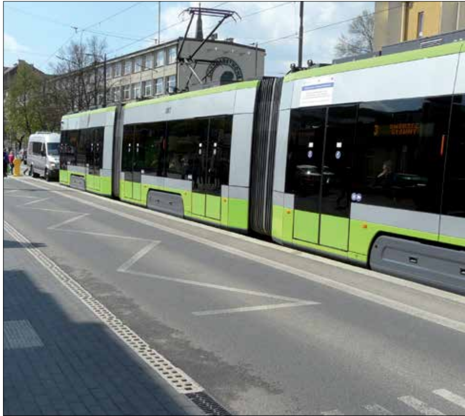
Fot. 2 | Przystanek tramwajowy typu wiedeńskiego (wyniesienie jezdni przy tramwaju)
