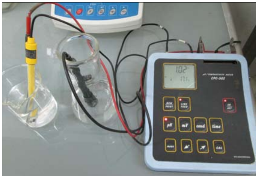
Fot. 7 | Pomiar odczynu środka do usuwania wykwitów z deklarowaną wartością \text{pH} < 5
