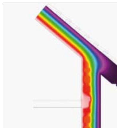
Przykład detalu z dokumentu „Analiza Liniowych Mostków Termicznych” przygotowanego przez Politechnikę Łódzką. Opracowanie kilkudziesięciu detali pomaga uniknąć mostków termicznych
