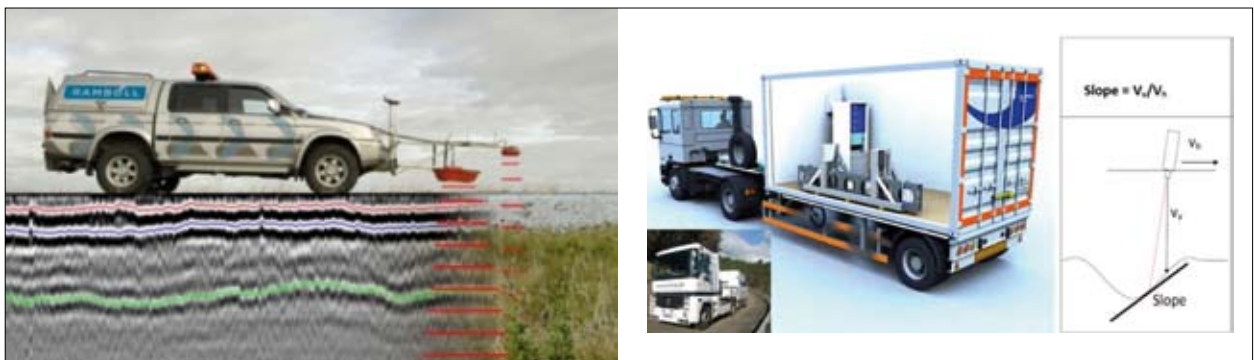
Rys. 1 | System pomiarowy GPR [ http://www.scopus.com.pl/uslugi/uslugi-dla-zaradcow-drog/diagnostyka-nawierzchni/ ] i ugięciomierz laserowy TSD [ http://www.ndtoolbox.org/content/pavement/d-physical-principle ]
