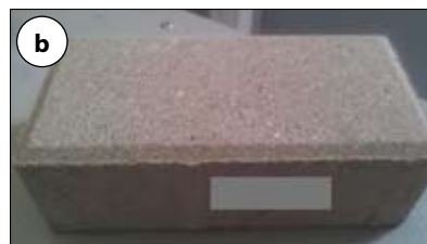
Fot. 6 | Wygląd powierzchni szarej kostki: a) przed katalogowym zastosowaniem środka H; b) po „katalogowym” zastosowaniu środka H
