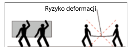
Rys. 2 | Zasady transportowania wielkowymiarowych okładzin
