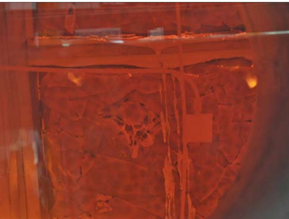
Fot. 7 | Widok nagrzewanej powierzchni aluminiowych profilowych drzwi o deklarowanej odporności ogniowej EI, 30 w 16 minucie badania
