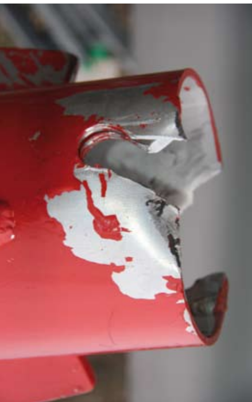
Fot. 3 | Segment podstawy masztu bezpośrednio po awarii
