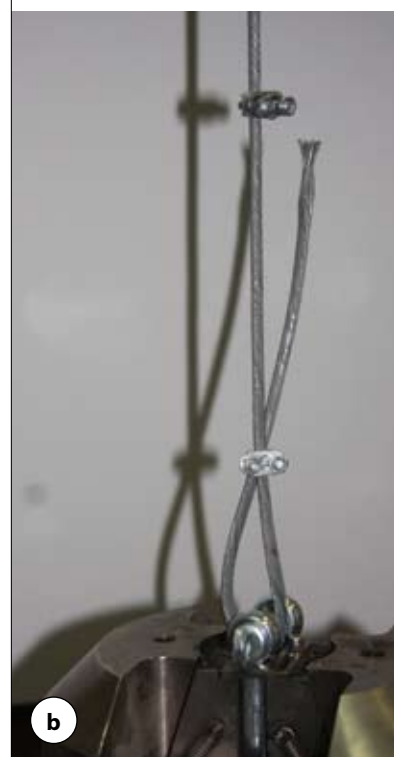
Fot. 6 | a) widok badanego zakotwienia liny odciągu w maszynie wytrzymałościowej; b) widok zakotwienia liny odciągu po badaniu – wysunięcie liny z zacisków
