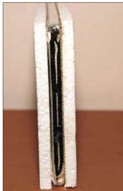
Fot. 3 | Próżniowy panel izolacyjny pokryty z obu stron warstwą styropianu [6]
