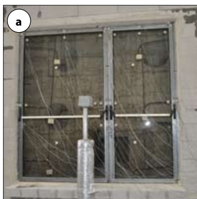
Fot. 1 | Widok nienagrzewanej powierzchni stalowych profilowych drzwi dwuskrzydłowych o deklarowanej odporności ogniowej EI 2 30: a) przed badaniem w zakresie odporności ogniowej, b) w 16 minutach badania, c) po badaniu
