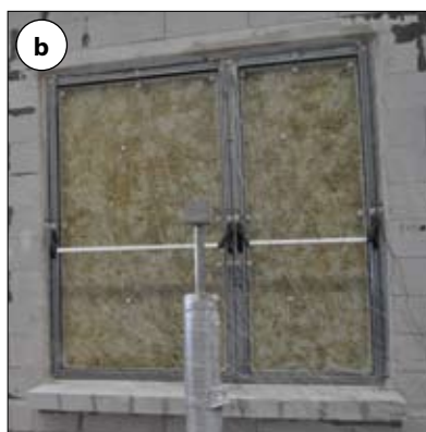
Fot. 1 | Widok nienagrzewanej powierzchni stalowych profilowych drzwi dwuskrzydłowych o deklarowanej odporności ogniowej EI 2 30: a) przed badaniem w zakresie odporności ogniowej, b) w 16 minutach badania, c) po badaniu
