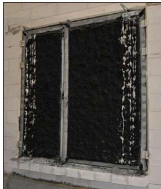
Fot. 2 | Widok nagrzewanej powierzchni stalowych profilowych drzwi dwuskrzydłowych o deklarowanej odporności ogniowej EI 2 30 po badaniu w zakresie odporności ogniowej
