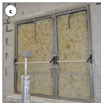
Fot. 1 | Widok nienagrzewanej powierzchni stalowych profilowych drzwi dwuskrzydłowych o deklarowanej odporności ogniowej EI 2 30: a) przed badaniem w zakresie odporności ogniowej, b) w 16 minutach badania, c) po badaniu
