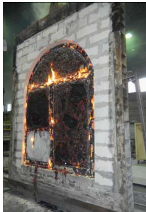
Fot. 4 | Widok nagrzewanej powierzchni drewnianych drzwi dwuskrzydłowych z nadświetłem w kształcie łuku, o deklarowanej odporności ogniowej EI, 60 po badaniu w zakresie odporności ogniowej
