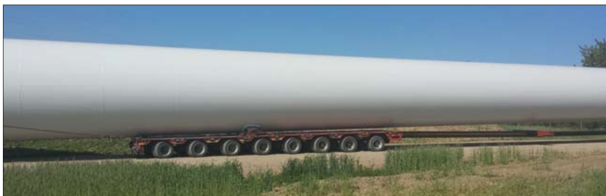
Fot. 6 | Transport segmentu wieży
