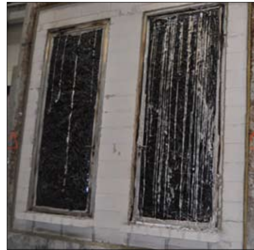
Fot. 6 | Widok nagrzewanej powierzchni aluminiowych profilowych drzwi jednoskrzydłowych (o wysokości ponad 3 m), o deklarowanej odporności ogniowej EI 30 po badaniu w zakresie odporności ogniowej
