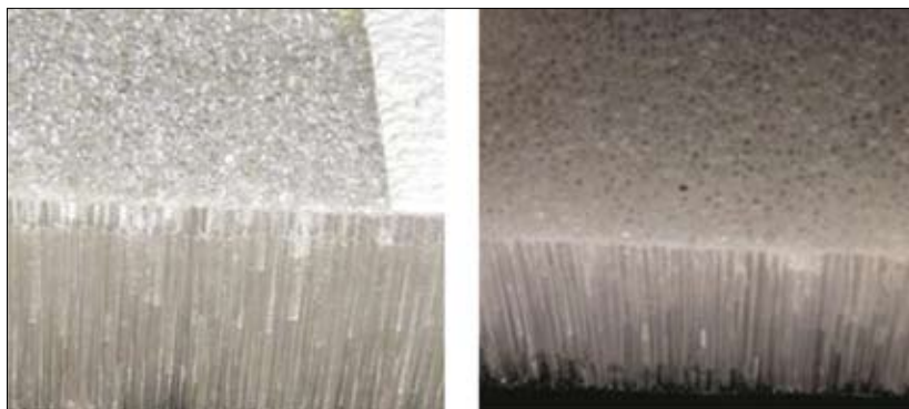
Fot. 1 | Próbką izolacji transparentnej opracowanej przez firmę Sto [5]
