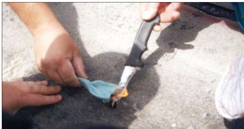
Fot. 5 | Spalanie gazu z pęcherza
