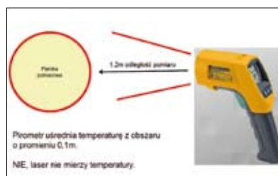
Rys. 3 | Pomiar temperatury piometrem to uśrednienie z pewnego obszaru [2]
