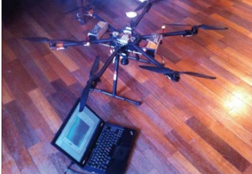
Fot. 2 | Wielowirnikowiec (multikopter) wyposażony w kamerę termowizyjną
