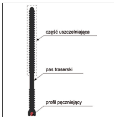
Budowa taśmy KAB
