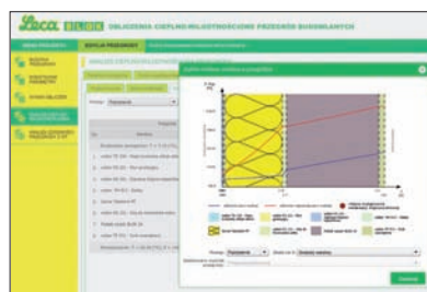
Fot. 4 | Miesięczne wykresy ciśnienia pary wodnej w warstwach przegrrody
