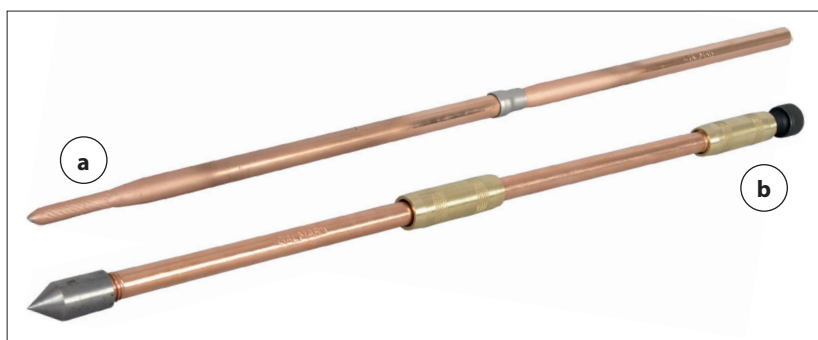
Fot. 1 | Uziomy pionowe pomiedziowane Galmar: a) gwintowany, b) kuty z powłoką Cu 250 µm
