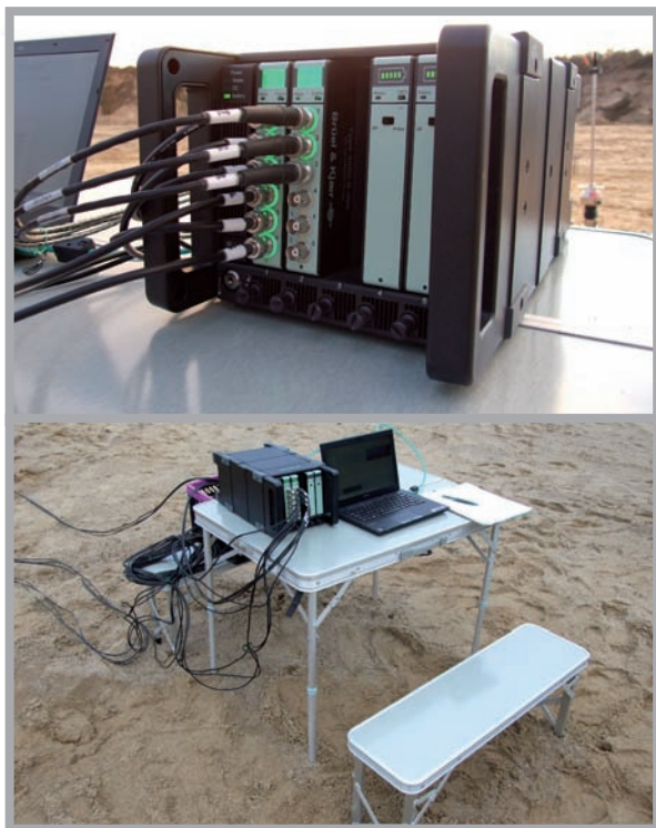
Stanowisko pomiarowe bazujące na układzie pomiarowym typu LAN-XI firmy Brüel & Kjær (fot. K. Czech)
