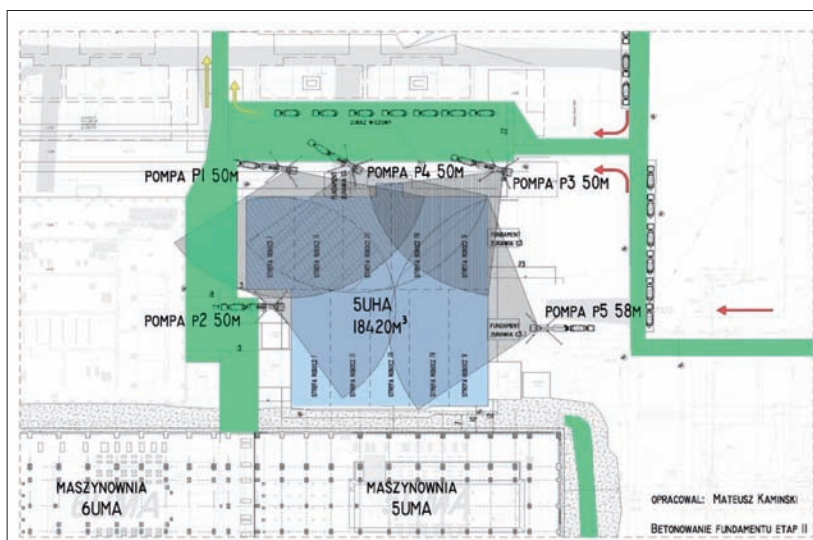
Rys. 3 | Plan betonowania i rozmieszczenia pomp – etap II
