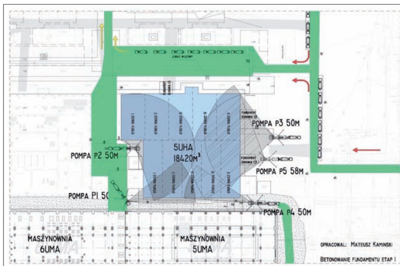
Rys. 2 | Plan betonowania i rozmieszczenia pomp – etap I
