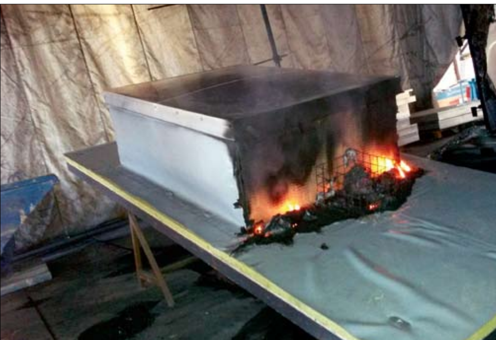
Badanie świetlika wraz z dachem pokrytym folią PVC
