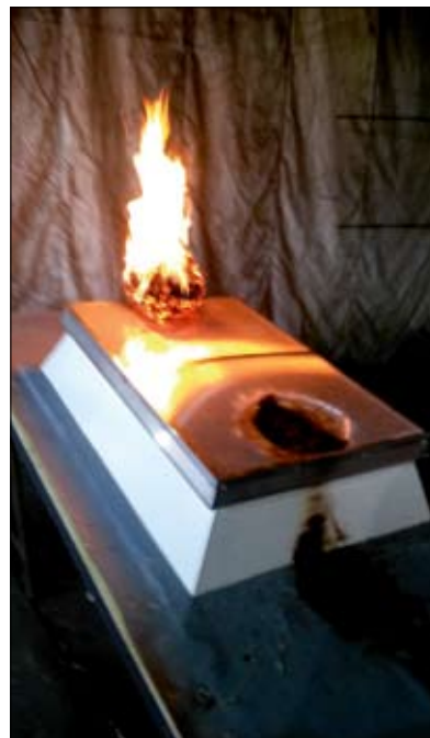
Badanie świetlika na podstawie z PVC. Badanie obejmuje zarówno pokrycie, jak i jego konstrukcję oraz podstawę
