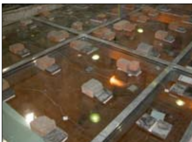
Fot. 21 | Dach o konstrukcji przeszklonej podczas badania odporności ogniowej – początek badania
