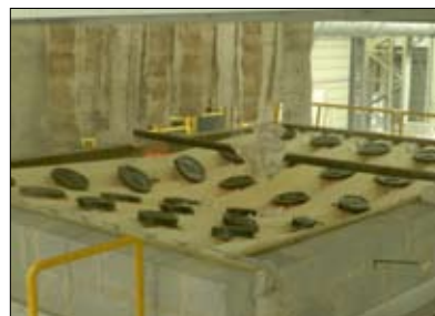
Fot. 27 | Dach w postaci stalowej blachy trapezowej podczas badania odporności ogniowej od strony nienagrzewanej
