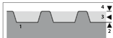
Rys. 1 | Schemat przestrzeni wypełnienia w posadzce z płytek: 1 – płytka, 2 – poziom odpływu (odwodnienia posadzki), 3 – przestrzeń wypełnienia, 4 – poziom użytkowy posadzki (płaszczyzna, po której się chodzi) (rys. Agrob Buchtal)
