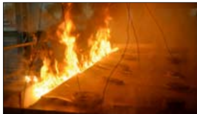
Fot. 8 | Dach z hydroizolacją w postaci membrany PVC oraz termoizolacją w postaci płyt typu PIR w czasie osiągnięcia kryterium szczelności ogniowej w badaniu odporności
