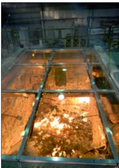
Fot. 22 | Dach o konstrukcji przeszklonej podczas badania odporności ogniowej – koniec badania
