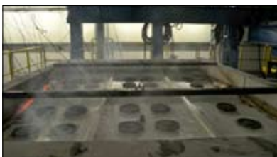
Fot. 17 | Dach z płyt warstwowych z rdzeniem z wełny mineralnej od góry podczas badania odporności ogniowej
