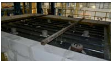
Fot. 14 | Dach z płyt warstwowych od góry przed badaniem odporności ogniowej
