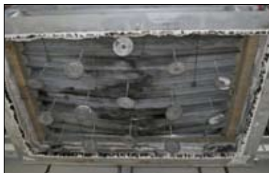
Fot. 11 | Dach warstwowy z termoizolacją z płyt EPS po badaniu odporności ogniowej od strony nagrzewanej
