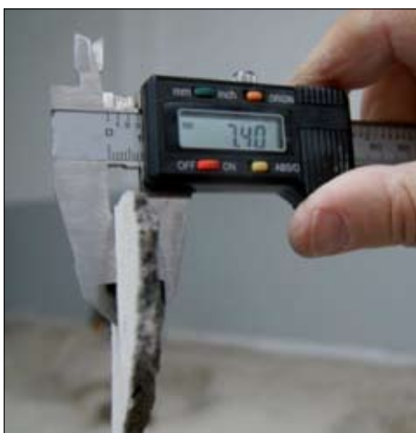
Fot. 13, 14 | Delaminacja warstwy wierzchniej posadzki wraz z warstwą utwardzoną i drobnym kruszywem niżej położonym
