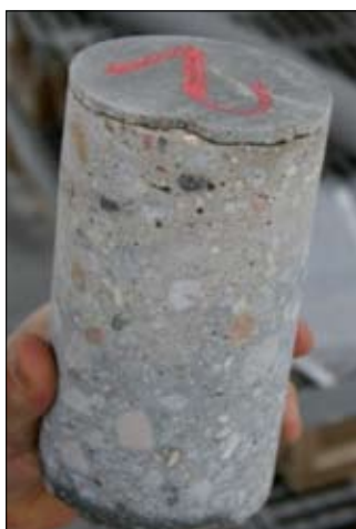
Fot. 13, 14 | Delaminacja warstwy wierzchniej posadzki wraz z warstwą utwardzoną i drobnym kruszywem niżej położonym
