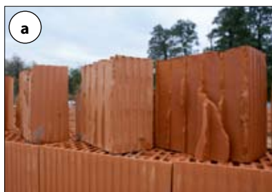
Fot. 5 | Pustaki ceramiczne „przycięte” siekierą (a) i wmurowane w ścianę (b)
