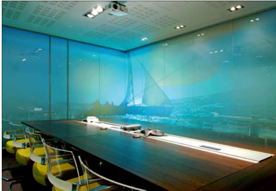
Szkło ze sterowaną przeziernością SGG PRIVA-LITE (fot. Saint-Gobain)
