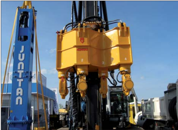
Fot. 5 | Maszyna bazowa z głowicą umożliwiającą wciskanie czterech elementów
