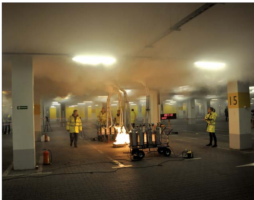
Fot. 3 | Próba dymowa z gorącym dymem służące weryfikacji skuteczności działania wentylacji pożarowej w obiekcie, wraz z oceną utrzymania dymu w jednej strefie dymowej (badania własne ITB)
