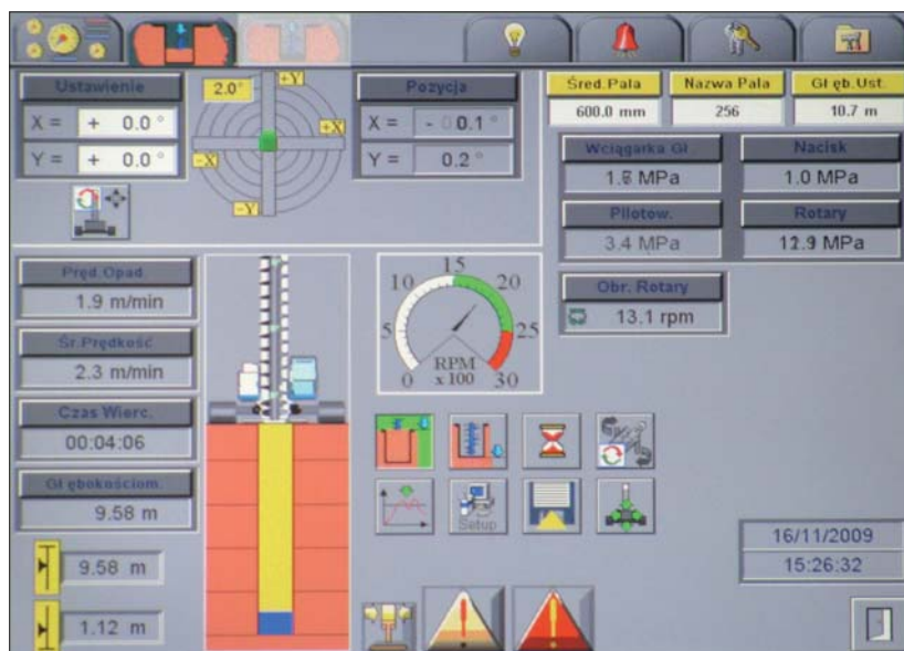
Fot. 4 Ekran sterujący w czasie wiercenia pali CFA
