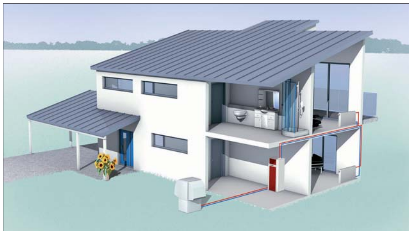
Rys. 4 | Układ pompy ciepła powietrznej w układzie jednostki zewnętrznej (źródło: Dimplex)
