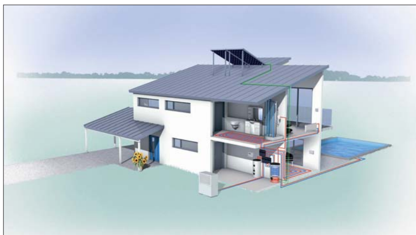
Rys. 5 | Układ hybrydowy pompy ciepła powietrznej połączonej z systemem ogniw fotowoltaicznych – PV (źródło: Dimplex)
