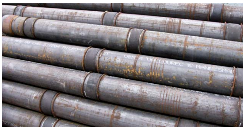
Fot. 10 | Rury z opaskami do iniekcji wielokrotnej mikropali
