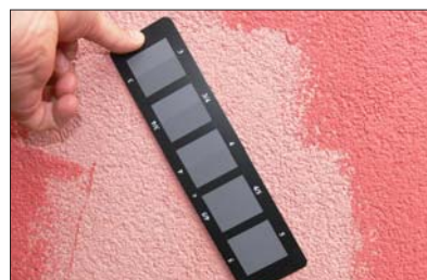
Fot. 3 | Zmiana barwy (wyblaknięcie) farby elewacyjnej po 2-letnim użytkowaniu obiektu w stosunku do nowo położonej warstwy tej samej powłoki
