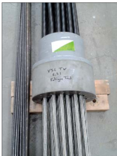
Fot. 2 | Elementy pojedynczej wandy systemu podwieszenia VSL spełniającej podwyższone wymagania w stosunku do wymagań określonych w aprobacie technicznej
