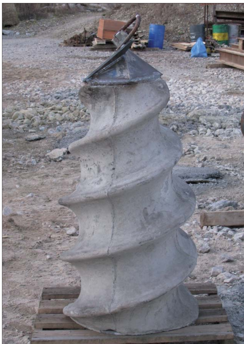
Fot. 1 | Spiralna stopa pala wykonana z żelbetu
