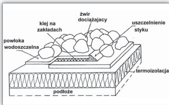
Rys. 7 | Sposób zabezpieczenia wodoszczelnej powłoki dachu na oderwanie przez wiatr za pomocą warstwy żwiru
