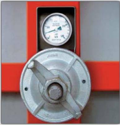
Fot. 1 | Przyrząd do bieżącego pomiaru ciśnienia mieszanki betonowej w deskowaniu
