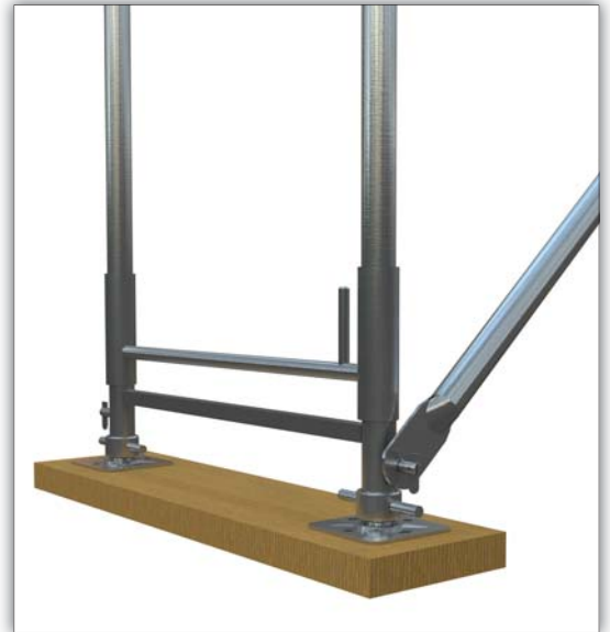
Rys. 2 | Prawidłowe posadowienie rusztowania na podkładach drewnianych
