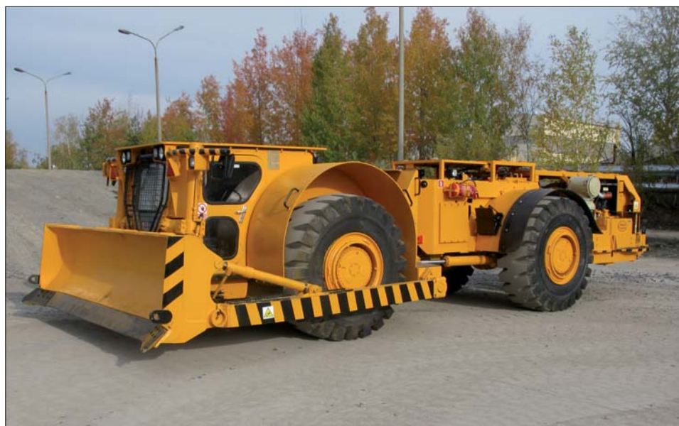
Fot. 2 | Spycharka kołowa firmy Zanam-Legmet
