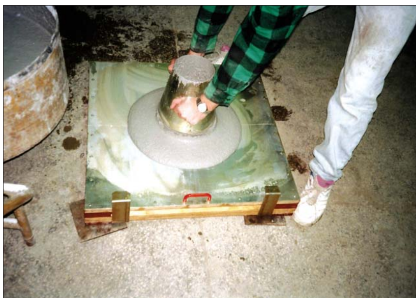
Fot. 3 | Kontrola rozlewności samozagęszczalnej mieszanki betonowej
