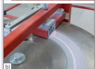
Fot. 3 | a) Pomiar ścieralności na tarczy Böhme: 1-badana próbka w uchwycie, 2-pas ścierania (posypywany proszkiem ściernym), 3-tarcza obrotowa, 4-ciężarek obciążający; b) Próbkę podczas cyklu ścierania
