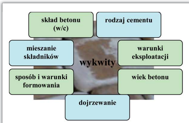
Rys. 4 | Czynniki wpływające na powstawanie wykwitów (opr. autorek)
