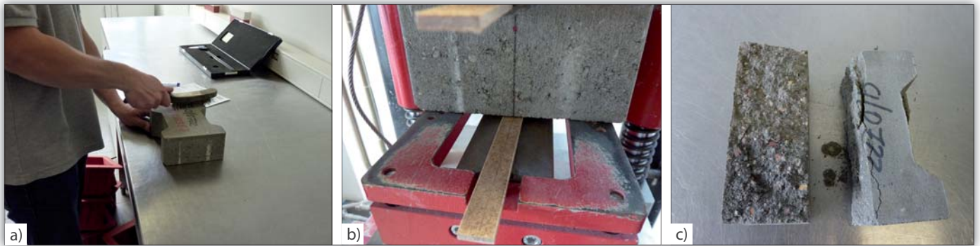
Fot. 4 | a) Przygotowanie powierzchni próbki do badań (usunięcie zadziorów); b) Badanie wytrzymałości na rozciąganie przy rozłupywaniu; c) Próbką po badaniu wytrzymałości na rozciąganie przy rozłupywaniu
