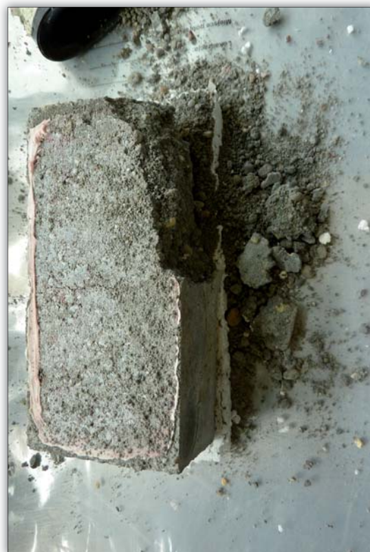
Fot. 7 | Kostka brukowa po badaniu odporności na zamrażanie/rozmarzanie (brak mrozoodporności)
