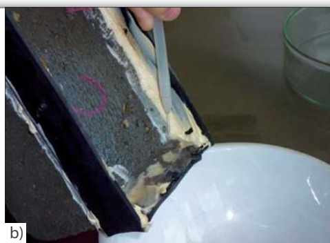
Fot. 1 | a) Próbkę w komorze podczas badania mrozoodporności; b) Zbieranie złuszczonego materiału z powierzchni badanej próbki
