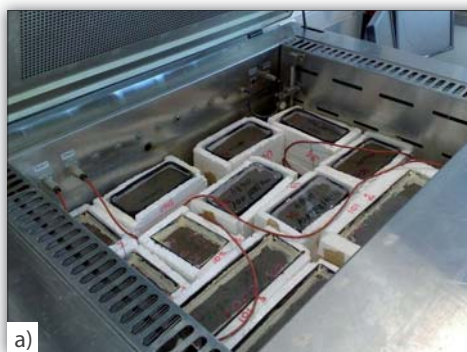
Fot. 1 | a) Próbkę w komorze podczas badania mrozoodporności; b) Zbieranie złuszczonego materiału z powierzchni badanej próbki
