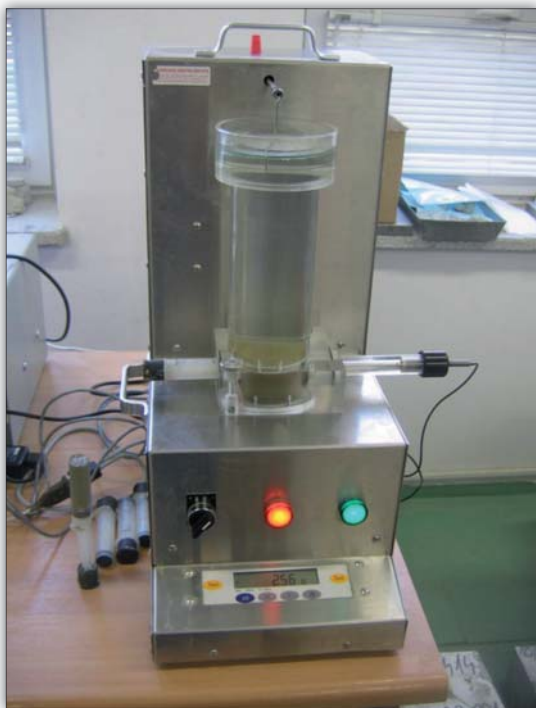
Fot. 2. Badanie struktury napowietrzenia mieszanki betonowej – aparat AVA
