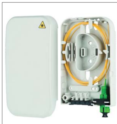
Fot. 6 Gniazdko światłowodowe służące do przyłączenia urządzenia aktywnego, tzw. ONT. W gnieździe można zakończyć jedno lub dwa włókna złączami standardu SC/APC. Na zdjęciu widoczna wersja z jednym włóknem światłowodowym, ale proponowane warunki techniczne przewidują obowiązek instalacji dwóch włókien do abonenta, dla zwiększenia neutralności technologicznej (np. możliwość uruchomienia zarówno sieci GPON, jak i Active Ethernet) i spełnienia wymogu dostępu otwartego (np. dla dwóch różnych dostawców usług)
