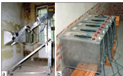
Fot. 2a i b | Osuszanie mikrofalowe przegrody
